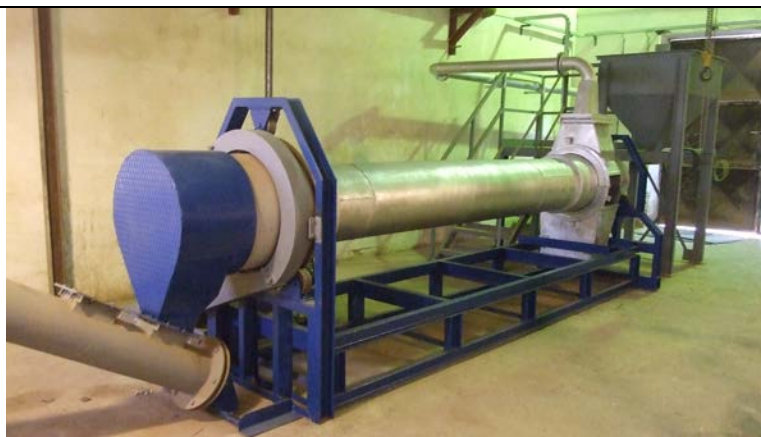
Obr.12 Experimentálna rýchlootáčková rotačná pec umiestnená na Detašovanom pracovisku VRP v areáli SMZ, a.s. Jelšava
